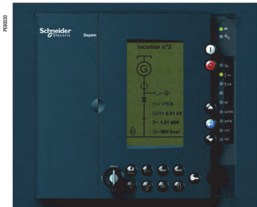
Местное управление с помощью мнемосхемы на графическом дисплее
