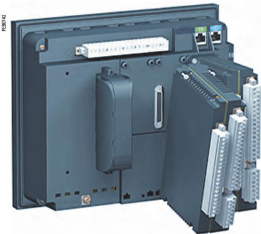
Максимальная конфигурация Serap серии 60 с 2 модулями MES 120: 28 входов и 16 выходов
